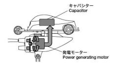
モーター駆動車を本体からはずしてスイッチをONにすると蓄電した電気で走ります。
