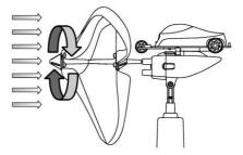
**2.**発電した電気は、モーター駆動車内のキャパシターに送られ蓄電します。
